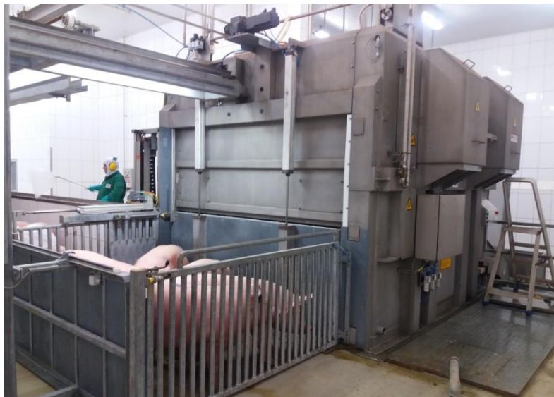
Figura 2. Insensibilizador de suínos com dióxido de carbono (CO 2 ). Fonte: Arquivo Pessoal.
